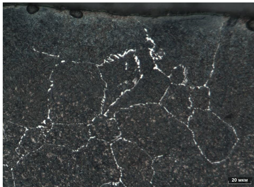
Рисунок 4.5 – Карбонитриды и карбиды в поверхностном цементованном слое по рабочей поверхности зуба детали, x 500.
