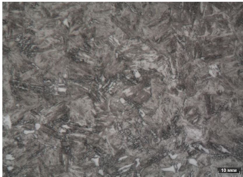
Рисунок 4.2 – Микроструктура сердцевины зуба детали, х 1000.
