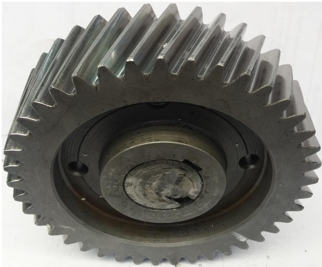
Рисунок А.11 – Внешний вид колеса первой ступени редуктора с ЭЦ зубчатый зацеплением после испытаний
