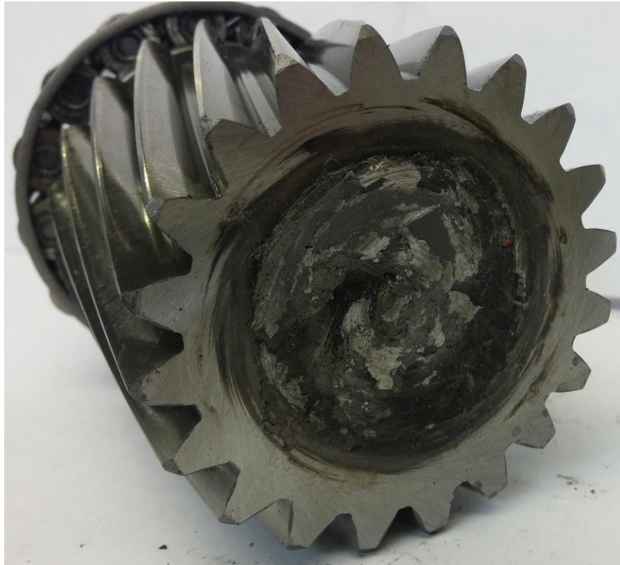
Рисунок А.13 – Внешний вид вала-шестерни редуктора с эвольвентным зубчатым зацеплением после испытаний
